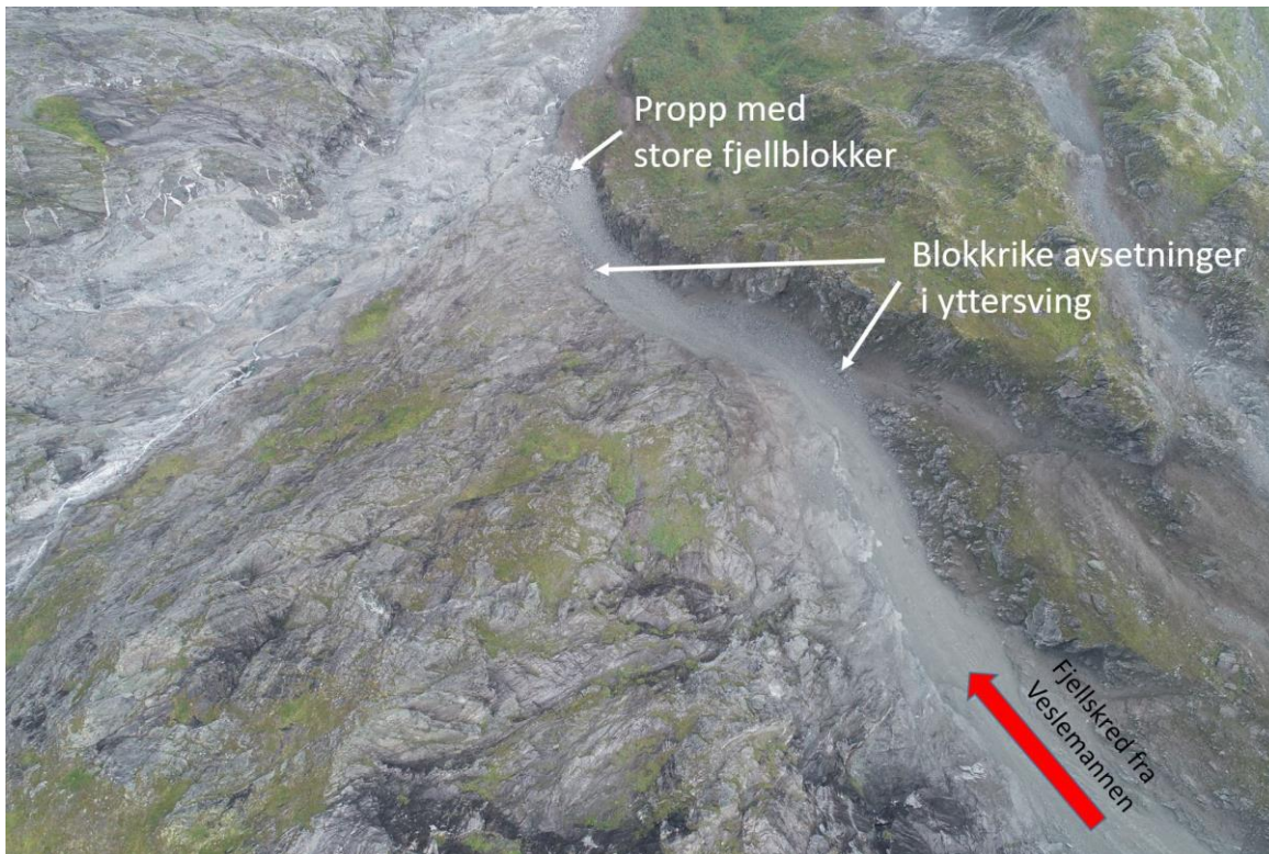
Figur 6. Dronebilde fra skredrenna som kommer fra Veslemannen (rød pil). Ser tydelig at det er en del finmasser i renna øverst, men at det ligger grovere material og store steinblokker i yttersvingene, og videre en propp eller tunge av store steinblokker i nedre del.
