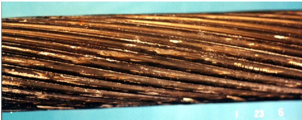
Figur 7. Stålaluminiumline med våtlakk. Spaltekorrosjon har oppstått under våtlakken, som har løst seg. Foto: S. Refsnæs.
