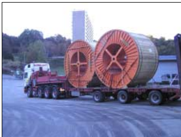
Figur 5.10: På disse tromlene er det 750 m 132 kV kabel på hver av dem. (Foto: BKK)
