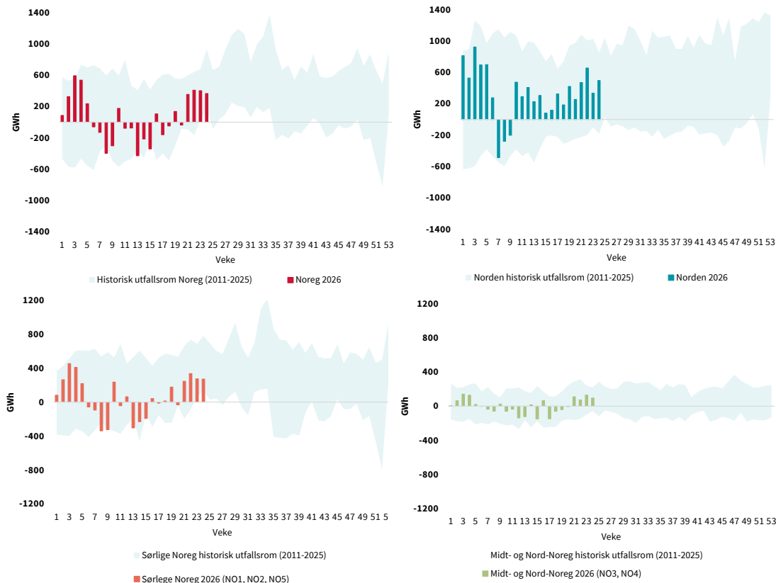
Figur 12 Nettoutveksling pr. veke for Noreg, Norden, Sørlege-Noreg (NO1, NO2, NO5) og Midt- og Nord-Noreg (NO3, NO4) i år og historisk utfallsrom. GWh. Kjelde: ENTSO-E
