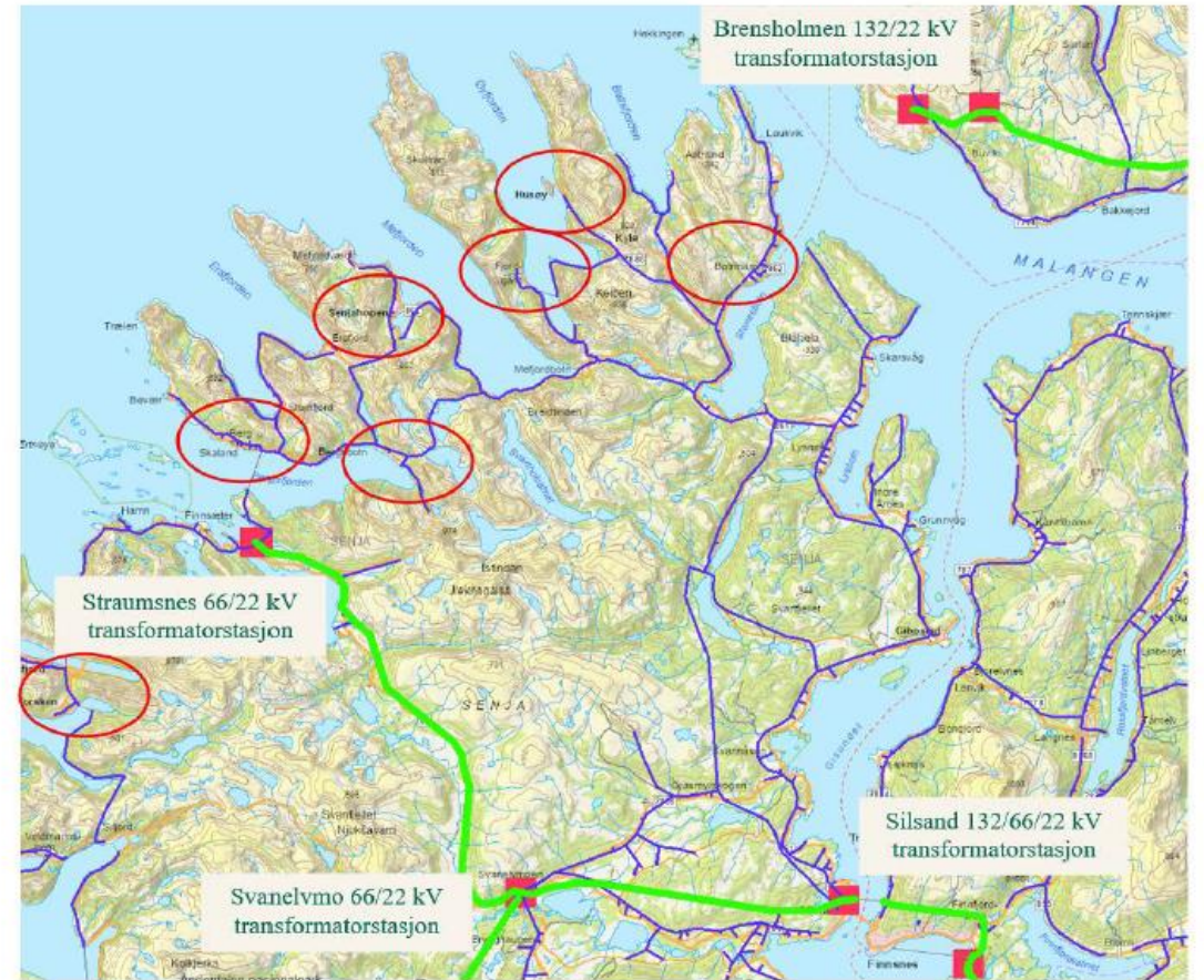
Figur 1 Oversiktsbilde over analyseområdet. Grønt er regionalnettet på 132 kV og 66 kV, blått er 22 kV distribusjonsnett og rødt er de største forbrukspunktene i analyseområdet på Nord-Senja.
