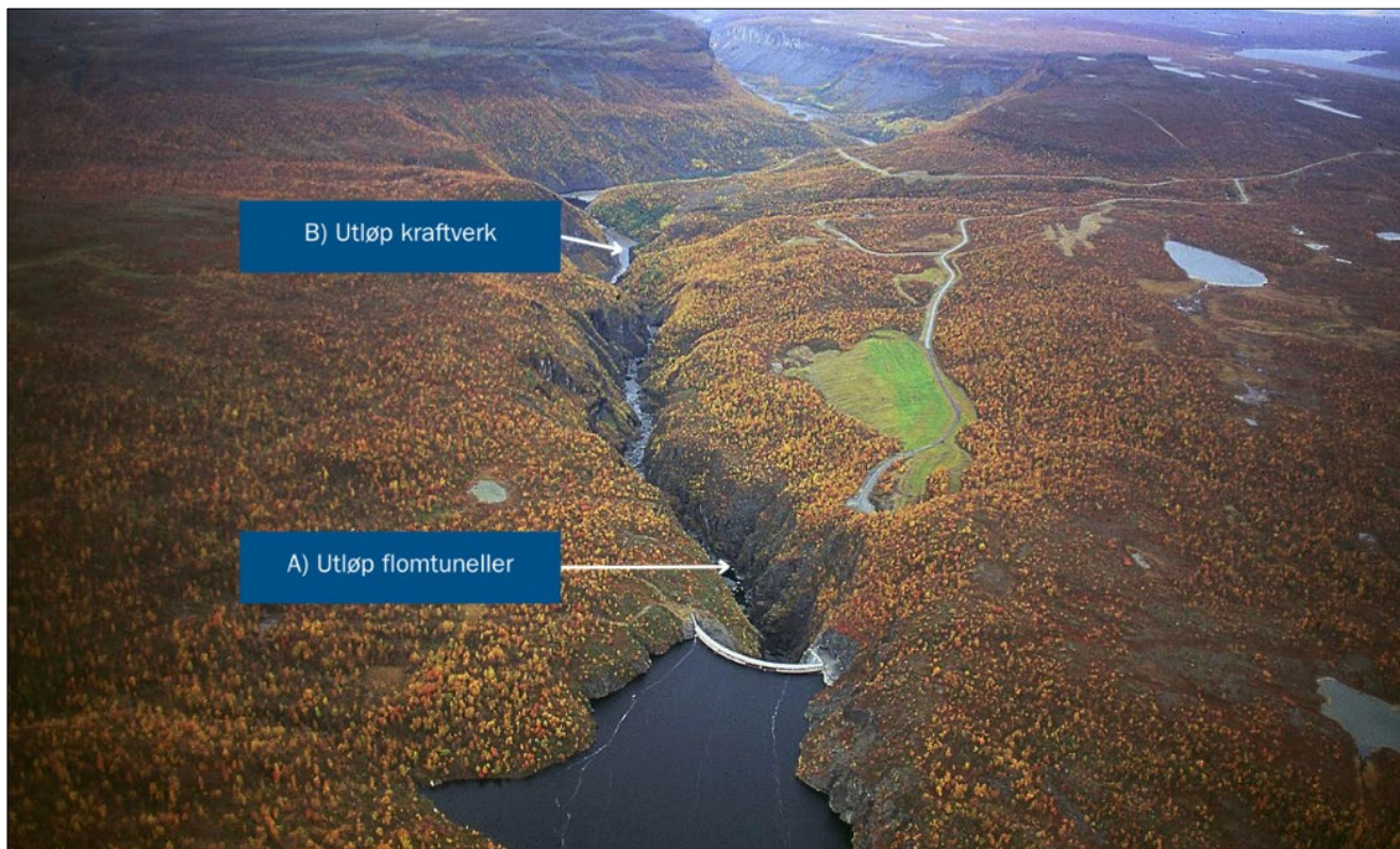
Figur 3. Strekningen mellom A) utløpet av flomtunellene og B) utløpet av kraftverket vil få redusert flomvannføring som følge av installasjon av aggregat 3. Elvestrekningen er ikke lakseførende. Foto: Statkraft.
