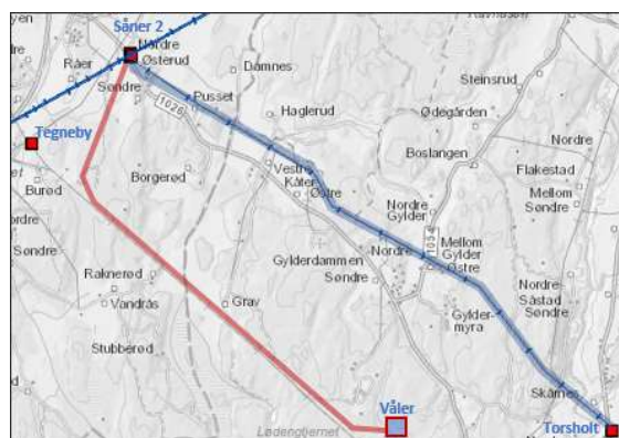
Figuren viser trase for ny kraftlinje, anlegg som fjernes og plassering av ny transformatorstasjon
