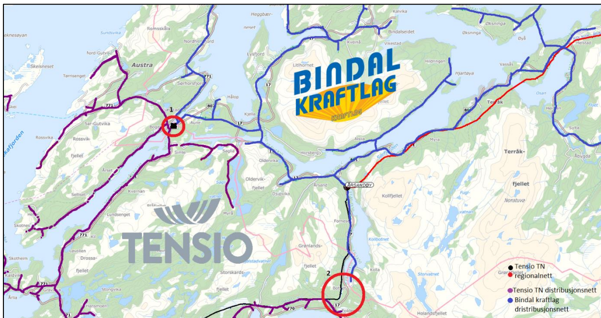
Figur 4-21 Grensesnitt Tensio TN mot Bindal Kraftlag i Valen
