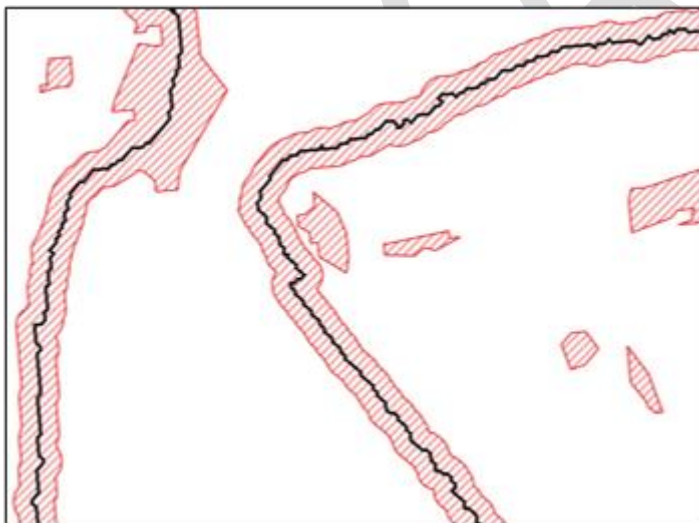
Figur 4 Lavpunkter som ligger utenfor buffersonen til dreneringslinjene (rødt skravert område rundt sort strek) utgjør selvstendige flater uten buffersone (enkeltstående skraverte flater i rødt). Lavpunkter som ligger innenfor buffersonen til dreneringslinjene, inngår i de samme flatene som dreneringslinjene, men uten å legge til en buffersone rundt lavpunktene.
