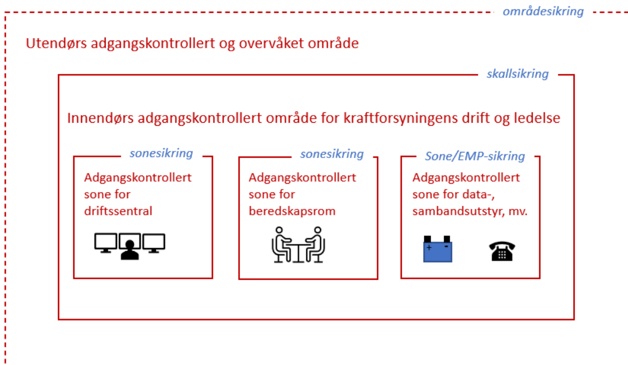
Figur 1 Prinsipp for område-, skall- og sonesikring mot adgang.
