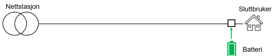
Figur 8: Forenklet radial som viser nettstasjon, kabel, kabelskap og kunde. Viser også plassering av batteri.
