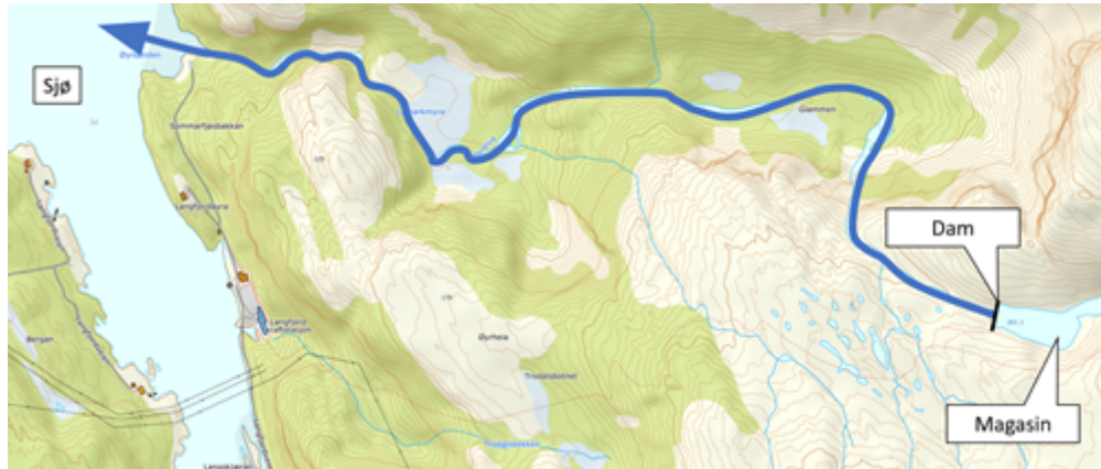
Figur 4: Eksempel på tilfelle der det er opplagt at dammen har ubetydelige bruddkonsekvenser (konsekvensklasse 0). Det er ingen bygninger, infrastruktur med betydning for liv og helse eller viktige miljøverdier mellom dammen og sjøen. Blå pil markerer hvor vannet vil renne ved dambrudd.
