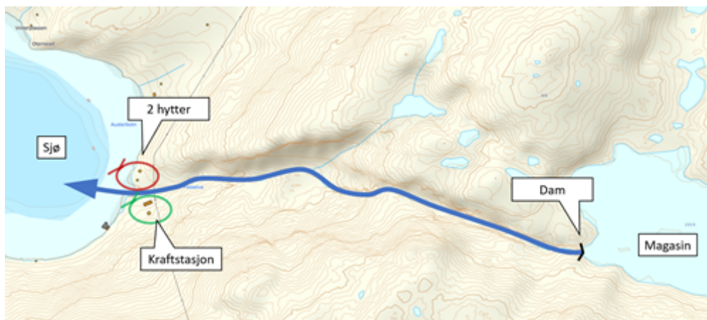
Figur 5: Eksempel der dambrudd kun kan berøre to hytter før vannet renner ut i sjøen. To hytter er mindre enn én boenhet (én hytte tilsvarer 0,08 boenheter), og tilsier derfor konsekvensklasse 1. Kraftstasjonen, som tilhører anleggseier, telles normalt ikke med ved klassifisering. Blå pil markerer hvor vannet vil renne ved dambrudd.
