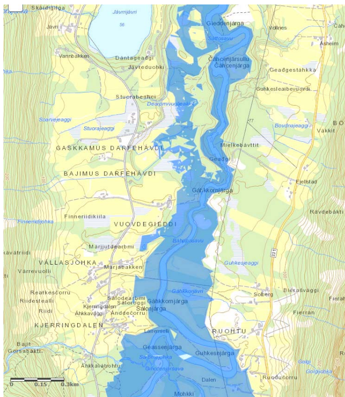
Figur 23 Området oppstrøms Vatnet som har dyp x hastighet større enn 2 \text{ m}^2/\text{s} er vist med blått.
