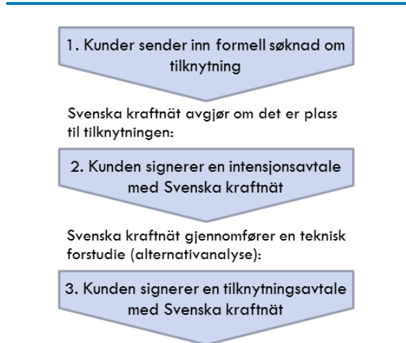
Figur 9-1 Prosess for tilknytning i transmisjonsnettet
