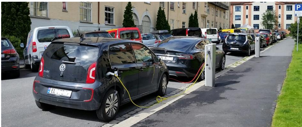
Figur 3-5 Lading av elbiler på offentlig ladestasjon. Foto:NVE
